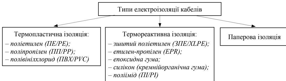
Рис. 2. Типи ізоляції силових кабелів
