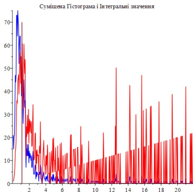
Рис. 4. Суміщена гістограма частоти аварійних перерв та їхнього зваженого внеску до показника SAIDI: короткі перерви ( t \leq m ) та довгі перерви ( t > m )
