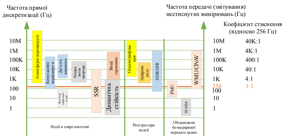
Рис. 1. Частотний склад подій мережі, кожна з яких представлена смужкою, що охоплює діапазон необхідних частот дискретизації Найквіста (ліва вісь); права вісь показує необхідну частоту звітності нестиснених вимірювань та необхідний коефіцієнт стиснення (відносно частоти звітності PMU 256 Гц).
